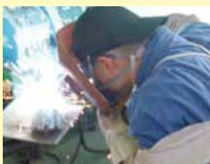
半自動アーク 溶接作業
