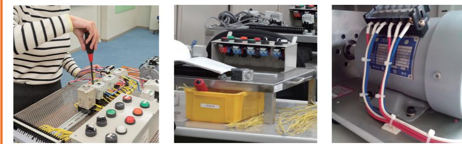
シーケンスは「手順」のことです。シーケンス図や制御機器の構造と機能に必要な知識を習得するとともに、電動機を運転するための制御回路と主回路の配線を通して実務能力を習得します。
