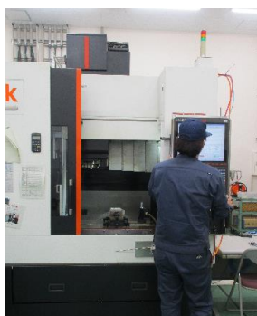
⑤パソコンから機械へプログラムを送ると... アクリル板を削りはじめます。
