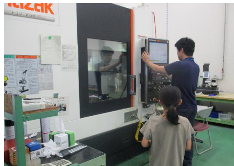
⑤パソコンから機械へプログラムを送ると・・・アクリル板を削りはじめます！
