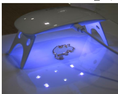
⑤魔法の液を流し込んだら 光を当てて固めていきます。
