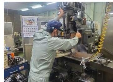
山田さんは、汎用フライス盤を担当しており、加工手順を自分で考え、図面通りに製品を加工し、ヤスリ等で製品の仕上げまで一貫して作業をしています。入社して1年半になりますが、ポリテクセンター宮崎で学んだ知識と技術を現場の仕事に活かしています。
