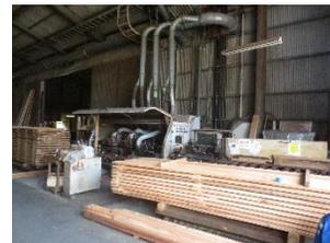
現在「モルダー」を担当し、木材加工を担当しています。読図を行いながら、柱などの構造材、筋かい・胴縁材などをお客様に応じて様々なサイズに加工し、現場やプレカット工場へ出荷しています。
