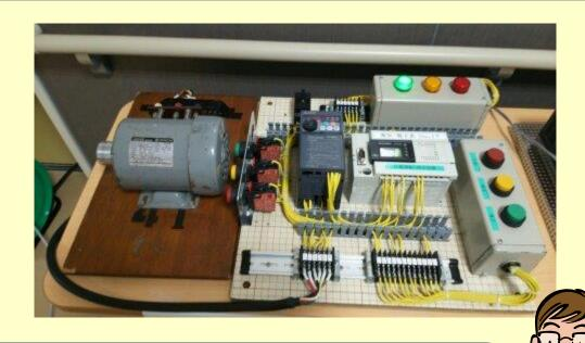
制御の概要から、シーケンス制御の特徴及び身の回りにあるシーケンス制御回路の紹介から入り、リレー・タイマリレーを中心とした各種機器の取扱及び PLC との連携での施工方法を実習形式で学ぶことができます。本セミナーで制御対象となる三相誘導電動機の原理・特性及びその代表的な制御回路の製作も学ぶことができます。
