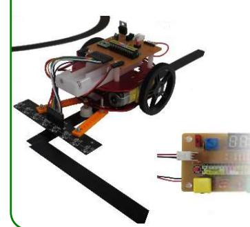
グループで自走ロボット（ライントラースカー）を作成することで、モノづくりの楽しさを体験します。周辺回路をマイコンで動かす関連知識を習得します。
