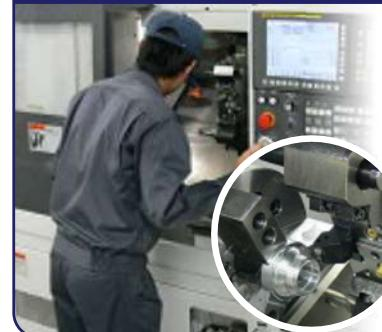
「旋盤」がプログラムで動き、加工するようになったものがNC旋盤です。ITが進んだ現在では主流となっている機械です。扱い方、プログラミング方法を学び仕事に必要な知識と技能・技術を身につけています。
