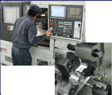
長さ測定、旋盤の切削技法と加工条件、NC旋盤の基礎知識、プログラミング手法及び、NC旋盤作業に関する技能と知識を習得します。
