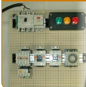
電動機などの自動制御（シーケンス）、受変電設備およびビル管理業務に関する知識と配線組立技能を習得します。
