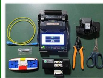
FTTHで使用する光ファイバでの通信配線に必要な光通信の知識、各種ファイバ接続法や配線の方法、検査に関する技術及び関連知識を習得します。
