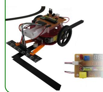
グループで自走ロボット（ライントレースカー）を作成することで、モノづくりの楽しさを体験します。周辺回路をマイコンで動かす関連知識を習得します。
