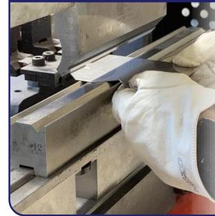
プレスブレーキ(ベンダー、曲げ加工機)の取り扱い、箱曲げ作業に関する技能と知識を習得します。
