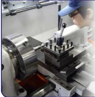
製造業で多く活用されている「旋盤」や「フライス盤」などの工作機械を実際に操作し、金属の切削加工を行います。切削加工に必要な知識と技能・技術の基本を身につけます。
