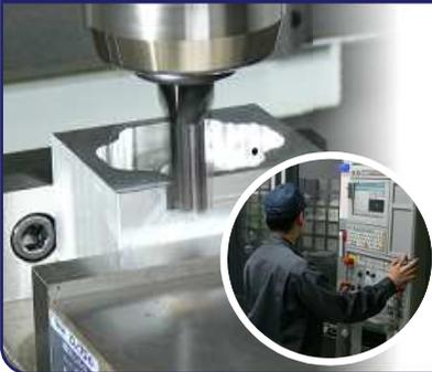
「マシニングセンタ」はNC旋盤と同様にプログラムで動き、加工します。一度にたくさんの工具を扱うことができ様々な加工を行うことができるため車のエンジン部品や産業機械の部品を製造できる機械の技能・技術を身につけます。
