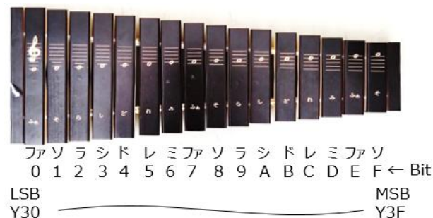
木琴側は 16 音階構成であるため、1Word (16bit) のデータを PLC の実出力 (Y30～) へ直接割り当てた。図 8 に示す。
