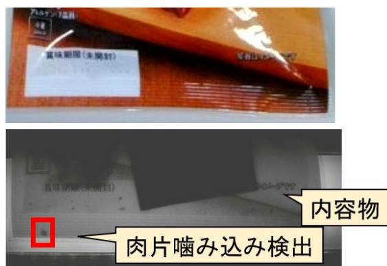
図 6 赤外線による検査画面
