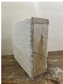
図 6 W 造蓄熱塗料試験体
