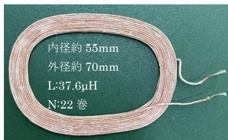
図 9 受電コイル(電車用)
