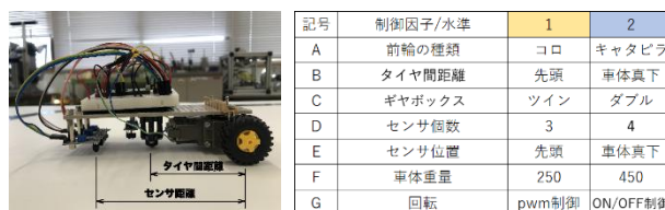
図 11 ライントレースカーと制御因子
