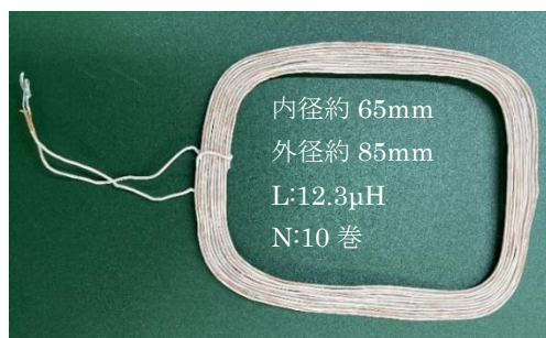
図 8 給電コイル(駅舎用)
