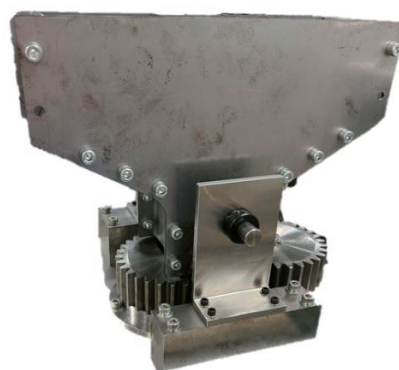
図 9 製作した方向判別整列ユニット
