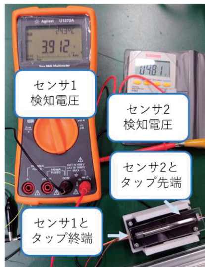
図 7 近接変位センサによる基礎実験
