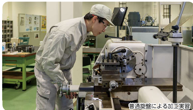
普通旋盤による加工実習
