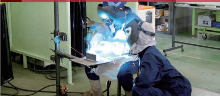
炭酸ガスアーク溶接に従事するための技能及び関連知識を習得します。
