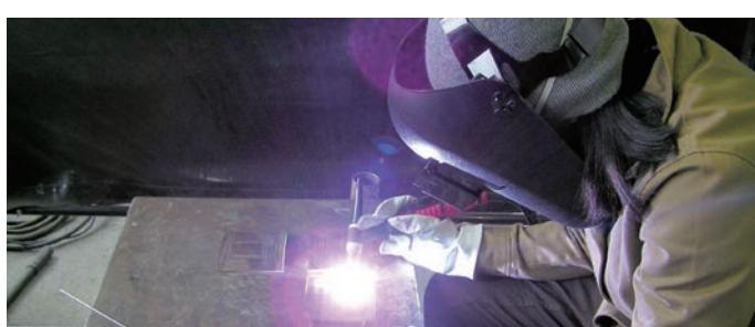
**メモ** TIG溶接とは、ステンレスやアルミの小型製品の溶接に適しています。火花が発生せず、特に細かい作業に向いています。松本周辺の地域では盛んに使用されている溶接方法です。
