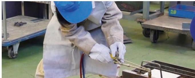
**メモ** ガス切断は酸素とアセチレンなどのガスを使用して鉄を溶かしながら切断しています。「ガス溶接技能講習」が取得可能です。また自由研削といしとは、材料を削るための電動工具などに取り付けて使用するといしのことです。
