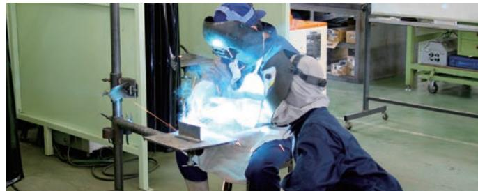
**メモ** 炭酸ガスアーク溶接は、細い金属ワイヤを自動で送給する溶接方法です。自動車や鉄骨など様々な分野で使用されていて、現在の溶接の主流です。
