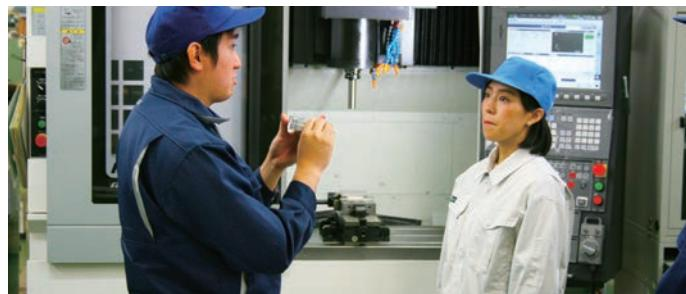
**メモ** マシニングセンタとは、NCプログラムにより丸棒や角材などの材料を複雑な形状の部品に切削するための機械です。フライス盤とは、工具を回転させながら丸棒や角材などを加工する機械です。表面や段差を加工したり、穴あけすることができます。
