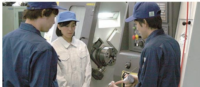
**メモ** 普通旋盤とは、材料を回転させながら刃物を使って主に円筒形状を加工する機械です。NC旋盤とは、プログラムで円筒状の金属を自動的に加工する機械です。
