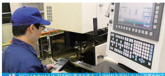
**メモ** NCワイヤカットとは、ワイヤに電流を流すことで材料を溶かしながら金属を加工する機械です。0.005mm(5μm)程度と精密な加工が可能です。
