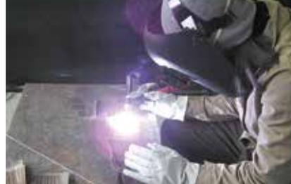
TIG溶接とは、非鉄金属や小型製品の溶接を得意とするアーク溶接法です。
