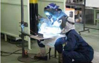
炭酸ガスアーク溶接は、溶接棒よりさらに細い金属ワイヤを自動で送給するため、連続溶接が可能です。
