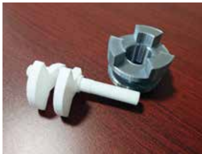
3Dプリンタを使い、樹脂で製作した機械部品の試作品
