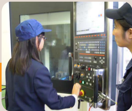
2. マシニングセンターでデザインした文字を彫り込む
