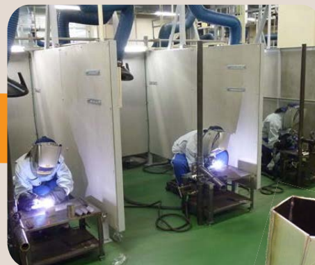
3. 溶接で土台の箱を作る
