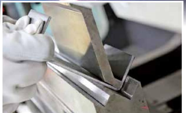
曲げ加工…板を機械で曲げて変形させます。板金工には必須の技術です。
