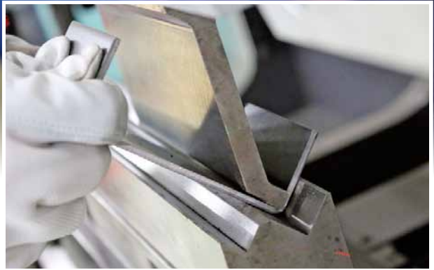
曲げ加工…板を機械で曲げて変形させます。板金工には必須の技術です。
