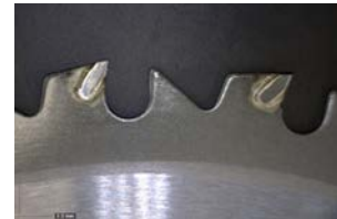
図 7 キックバック対策竹専用チップソー(日光製作所)
