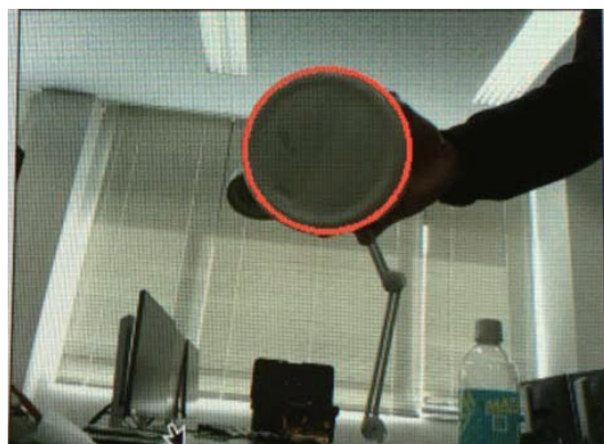
図 3 OpenCV を用いたカメラ映像の画像処理による丸い物体の検知・認識
