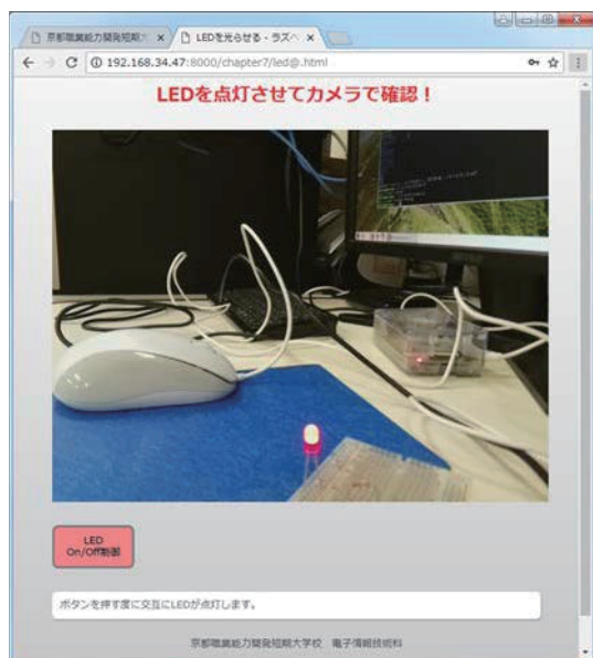
図 2 Web ブラウザから LED の ON/OFF 制御
