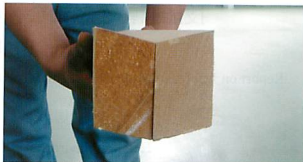
図4 振れ垂木の断面形状
