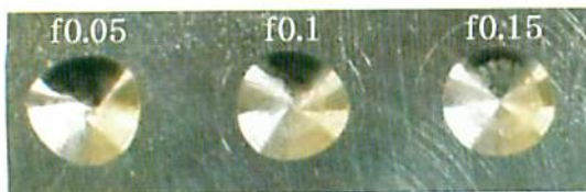
図23 加工方法①における穴入口の状態
