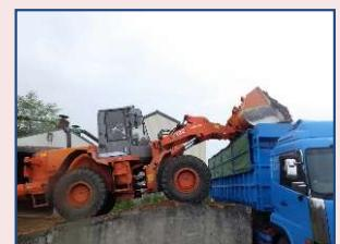
運搬：破碎した木材をホイールローダー等でトラックに積込み
