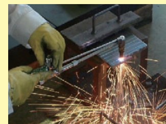
▲ ガス切断の実習風景
