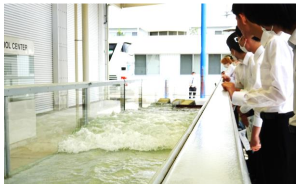
【(株)技研製作所】 地震や津波に強い「インプラント構造物」 津波耐波実験を見学
