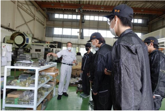
【(有)伊藤工作所】部材の説明、マシニング 自動切削の加工の説明
