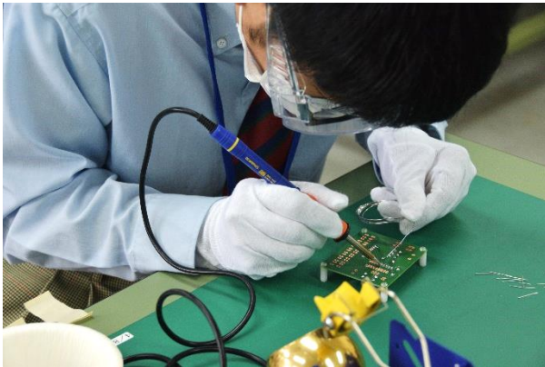
はんだ付けをして固定します。はんだがきれいな富士山の形になるよう気を配ります。
