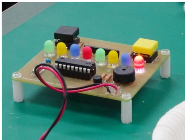
「電子ホッケー」完成です♪球の動きにみせかけたLEDランプの動きに対し、タイミングよくボタンを押し打ち返します。ラリーを続けられなくなった方が、負けです。
