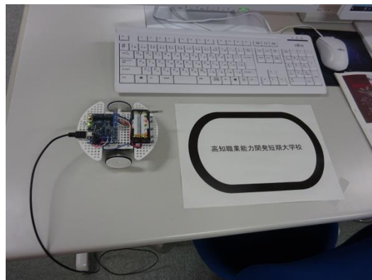
マイコンとセンサを搭載したライトレースカー。黒のラインの上を上手に動かせるかな
