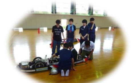
酸素と水素の化学反応で出来た電気エネルギーで走る車「FCV」
