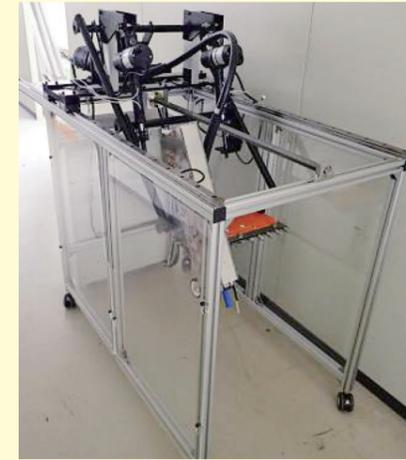
うどん県である香川県では、うどんの薬味に欠かせない葉ネギが県下全域で栽培されています。収穫は、根を必要としないため、年2、3回実施し、手刈りのため多くの労力が必要となっています。収穫の労力を軽減する目的で県内の企業が収穫機を開発中であるが、地面の凹凸により刈り刃の高さを調整できないため、土壌の高低差に関係なく一定の高さで刈り取れるシステムの開発に取り組んでいます。刈り取り高さが10mm変動すると、100m×100mの畑で約1tの収穫量の改善が見込まれるため、刈り取り高さを一定にすることで作業者の負担の軽減に貢献できます。
