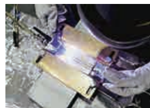
ステンレス薄板(3mm) 下向き突合せ溶接
