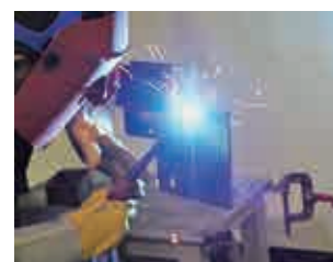
中板(9mm)立向き突合せ溶接
