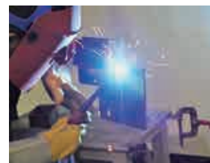
中板(9mm)立向き突合せ溶接
