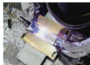
ステンレス薄板(3mm) 下向き突合せ溶接
