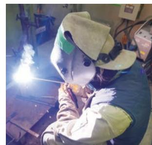
**目標** 溶接加工の現場力強化及び技能継承をめざし、被覆アーク溶接作業の各種姿勢の溶接実習等を通して、適切な被覆アーク溶接施工に関する技能と実際に起こりうる品質上の問題点の把握及び解決手法を習得する。
