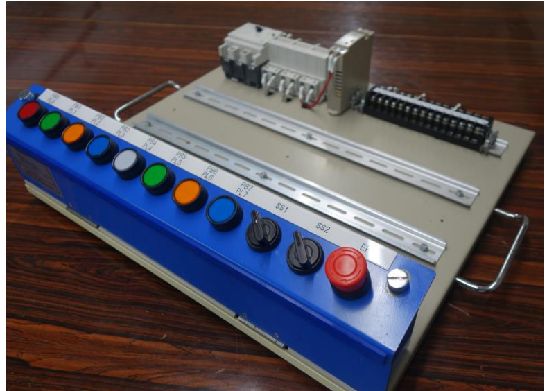
【使用機器】実習用制御盤
