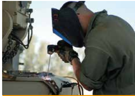
被覆アーク溶接作業
