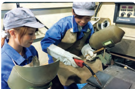
炭酸ガスアーク溶接作業
