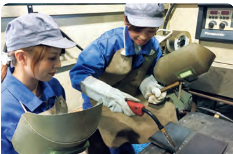
炭酸ガスアーク溶接作業
