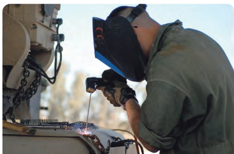
被覆アーク溶接作業
