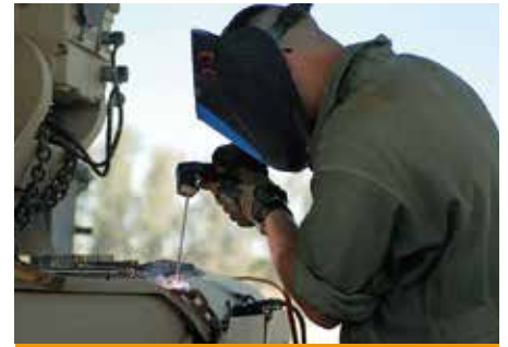
被覆アーク溶接作業
