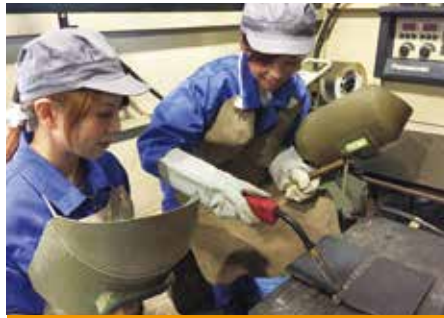
炭酸ガスアーク溶接作業
