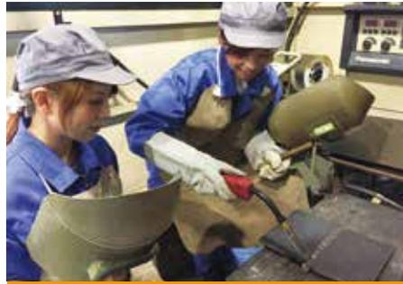
炭酸ガスアーク溶接作業
