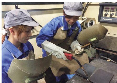
炭酸ガスアーク溶接
