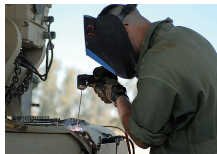
被覆アーク溶接
