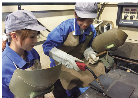
炭酸ガスアーク溶接
