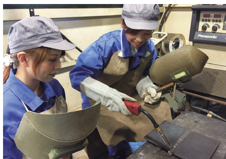
炭酸ガスアーク溶接
