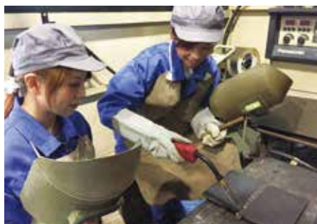
炭酸ガスアーク溶接
