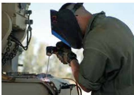
被覆アーク溶接
