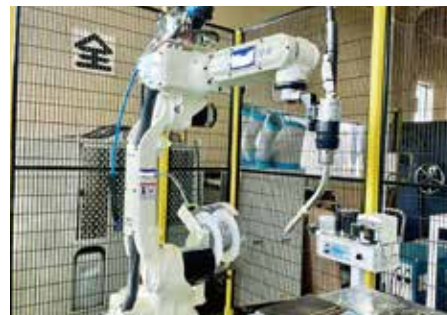
溶接ロボット
