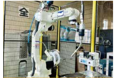
溶接ロボット
