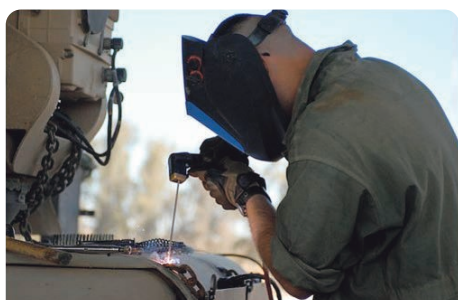
被覆アーク溶接作業
